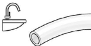
Uponor Aqua Pipe Rohre werden aus hochwertigem vernetzten Polyethylen hergestellt und sind sowohl in der Trinkwasser-Installation in der Etage als auch als Verteilleitungen einsetzbar.
