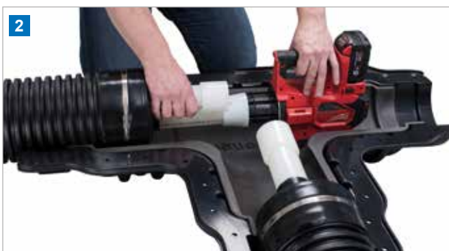
2 Rohrende und Q&E Ring aufweiten. Dabei wird der Aufweitkopf im Rohrende durch die spezielle Werkzeugmechanik automatisch gedreht.
