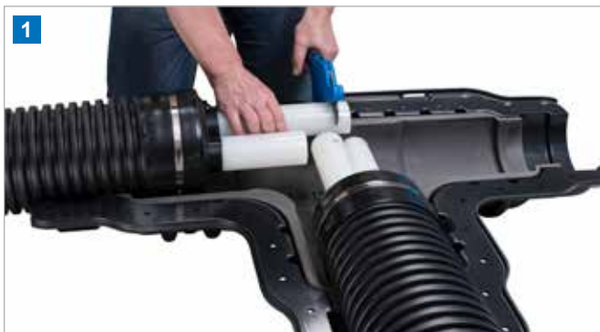
1 Mediumrohr rechtwinklig auf die passende Länge abschneiden und anschließend den Q&E-Ring auf das Rohrende aufstecken
