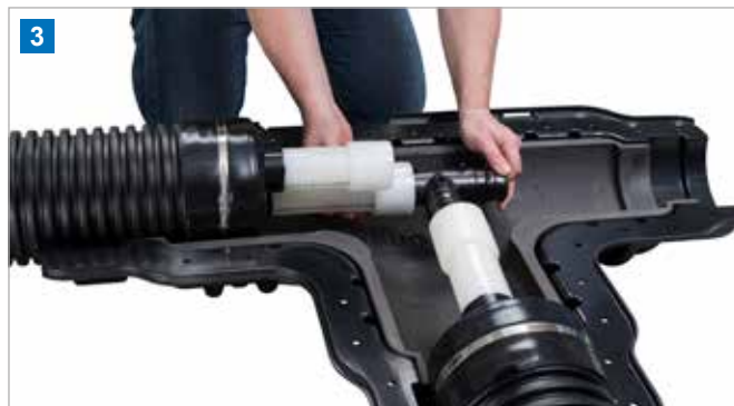
3 Das aufgeweitete Rohrende zügig bis zum Anschlag auf den Fittingnippel aufschieben und kurz halten, bis das Rohr aufgeschrumpft ist. Fertig!
