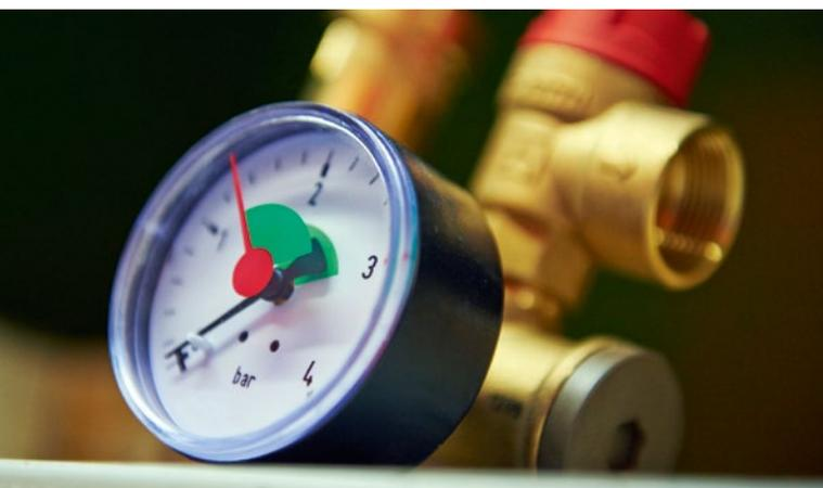
einer Prüfzeit von mind. 10 Minuten darf kein Druckabfall am Prüfdruckmessgerät, feststellbar sein. Für die Prüfung sind geeichte Messgeräte, auf denen Druckänderungen von 0,1 bar ablesbar sind, einzusetzen.
